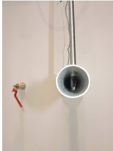
Messung mit Hitzdrahtanemometer an rohrförmiger Messstrecke am Prüfstand der HFA. Foto: Holzforschung Austria
