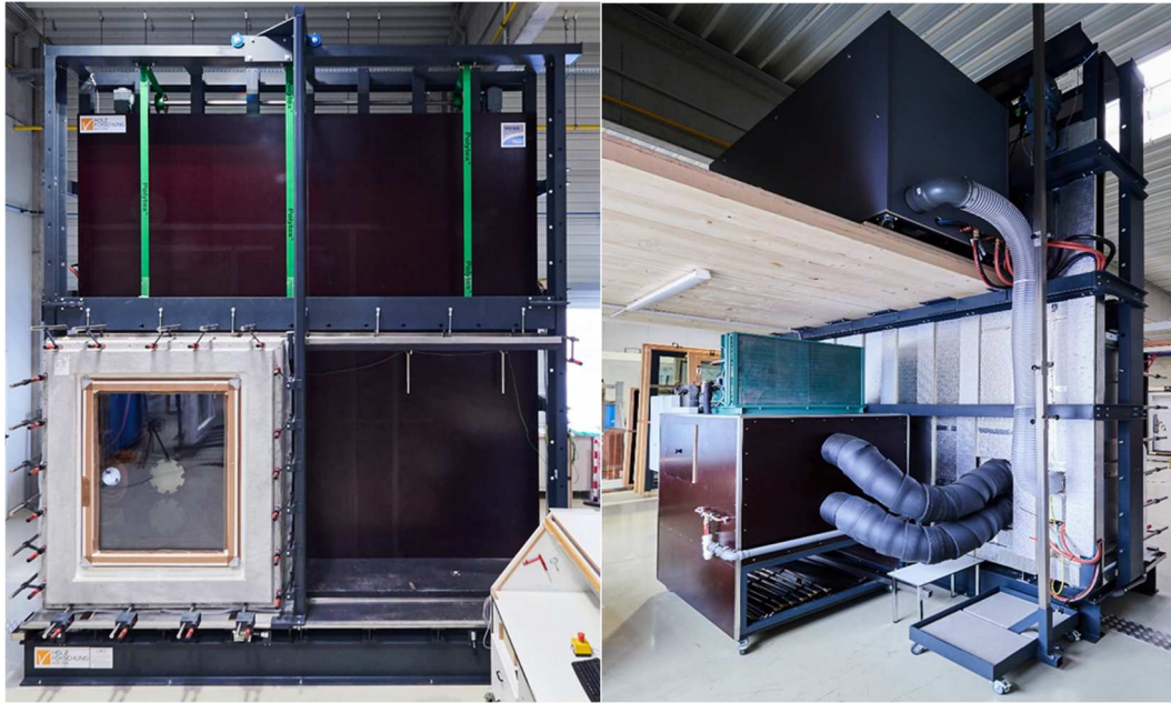
Versuchseinrichtung zur Ermittlung örtlicher Leckagen links: Messfeld (max. Breite 3,80 m, max. Höhe 3,66 m) rechts: Energie- u. Klimateinheit ( \pm 10 Pa bis \pm 5000 Pa; 0,2 m 3 /h bis 3000 m 3 /h; -20 °C bis +60 °C) Foto: ©ACR/schewig-fotodesign
