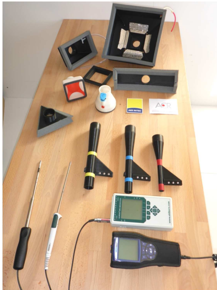
Messsondenausrüstung - 2 Hitzedrahtanemometer (unten im Bild), 3 Rohrstücke mit verschiedenem Durchmesser für unterschiedliche Leckagengrößen (Mitte) und dazugehörige Messadapter (oben im Bild) für Messungen auf einer Baustelle. Foto: AEE INTEC
